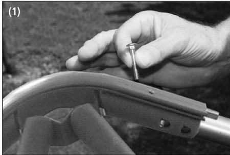
(1) Verbinden Sie die ersten 6 Stangen mit Hilfe der beiliegenden Schlossschrauben mit dem Mittelstück.
