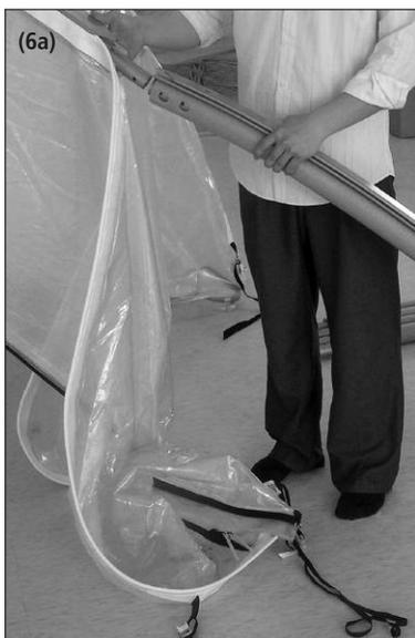
(6a-6c) Verbinden Sie nun die sechs unteren Gerüststangen mit Hilfe der Schloßschrauben mit den oberen. Durch diese Verbindung erhöhen Sie den Florino XL auf seine endgültige Größe von 2,80 m
